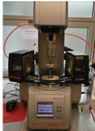
Abb. A 4.1: Versuchsaufbau, Rheometer
